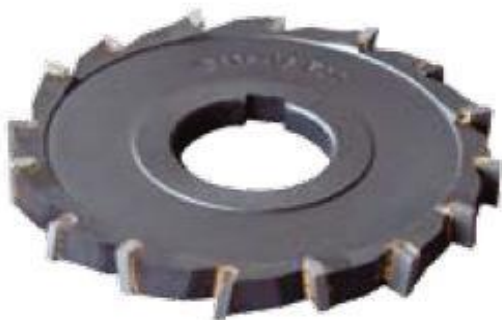
DIN8047 - Фрези дискови тристранни със запоени твърдосплавни пластини
